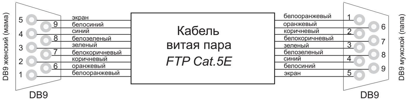
Рис. 2. Распайка соединительного кабеля.
