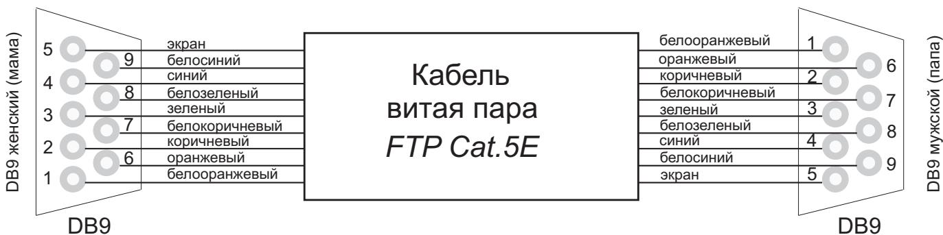
Рис. 2. Распайка соединительного кабеля.
